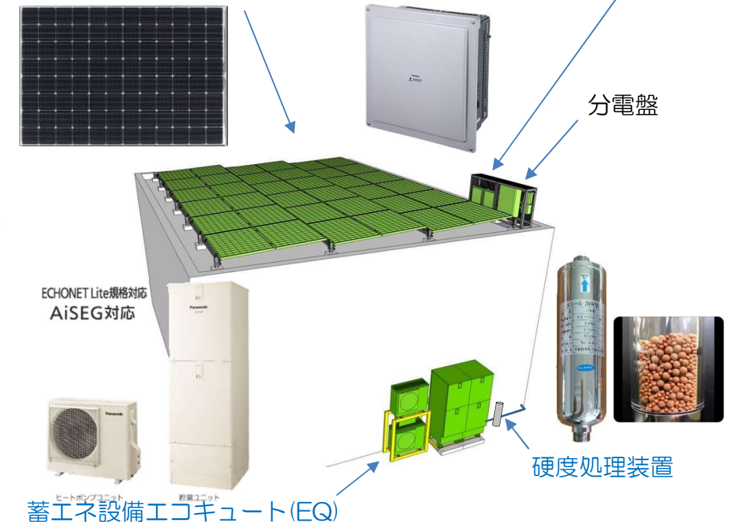
太陽光発電設備(PV) パワーコンディショナー(PV-PCS)
