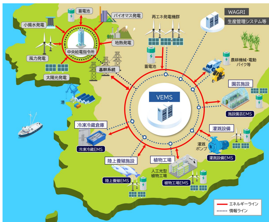
農山漁村における自律分散型エネルギーシステムの構成イメージ 1
